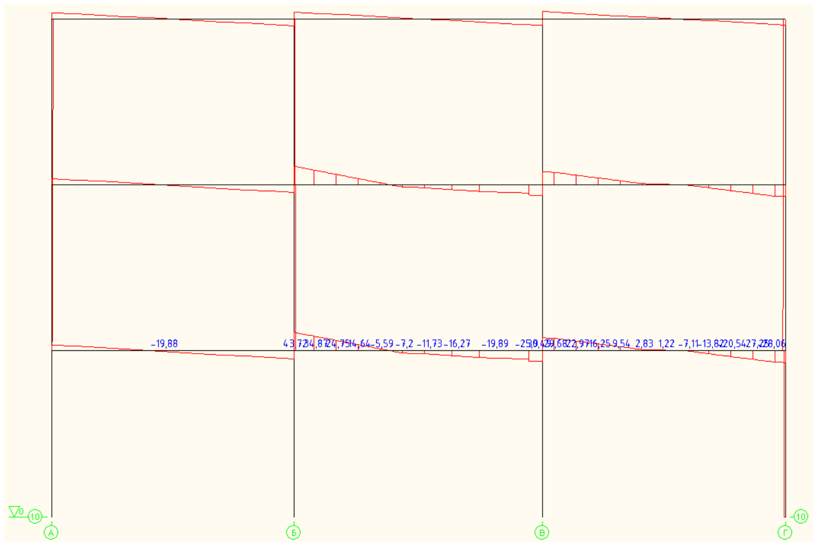
Пролёт в осях «10/А-Г». Эпюра усилий Q, т.
