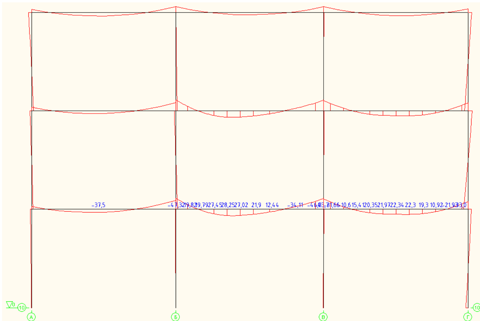
Пролёт в осях «10/А-Г». Эпюра усилий М, тм.
