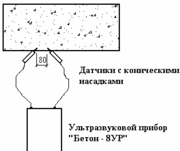
Схема УЗ анализа прочности бетона
